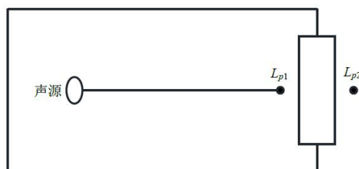
图 4-2 室内声源等效为室外声源图例
